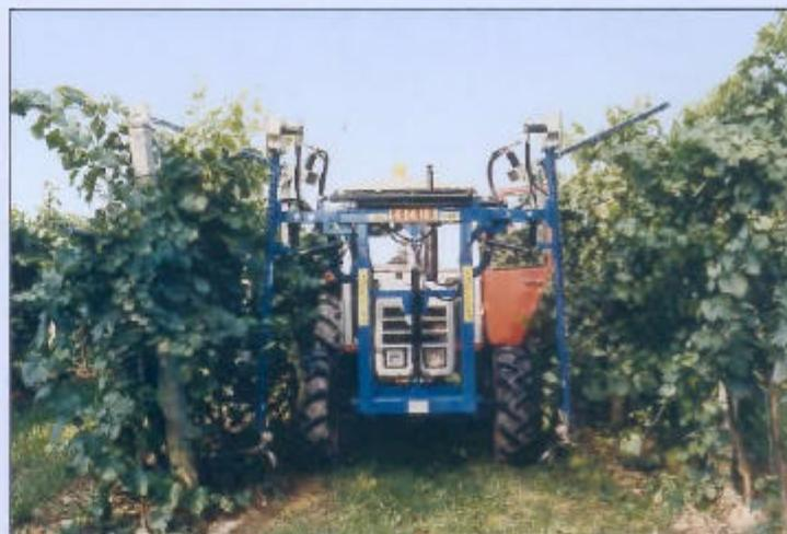
Cimatrice **I.ME.CA.** a barre bilama con denti in acciaio temprato. Il tipo di dente a forbice permette un taglio netto e un'elevata velocità anche in presenza di una forte vegetazione.
