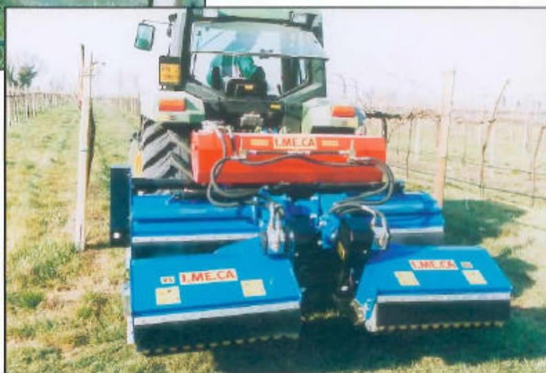
La trinciatrice Comby è stata costruita per risolvere le esigenze di pulizia nei vigneti e nei frutteti. Grazie al sistema di apertura idraulica delle testate trincianti si può variare la capacità di taglio in un'unica passata a seconda della distanza interfilare delle piante, riducendo notevolmente i costi.
